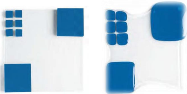
図4: デザイン部のガラスを縁ギリギリに置いて焼成した結果、元の形から大きく変形した。
