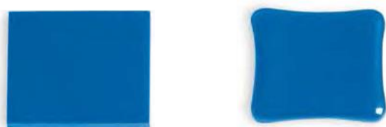
図3:3mmを1枚で816°Cで焼成。 縁が内側へひっぱられている。
