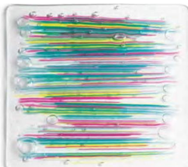
図6: 焼成中縁周りが先に溶け、空気の逃げ道をふさぎ、空気を閉じ込めてしまった。
